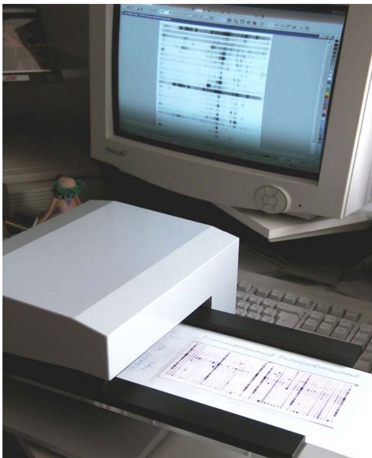
I/67. ábra. A szkennert úgy alakítottuk ki, hogy egyszerre csak egyetlen, 26 mintát hordozó blot képét dolgozza fel.
